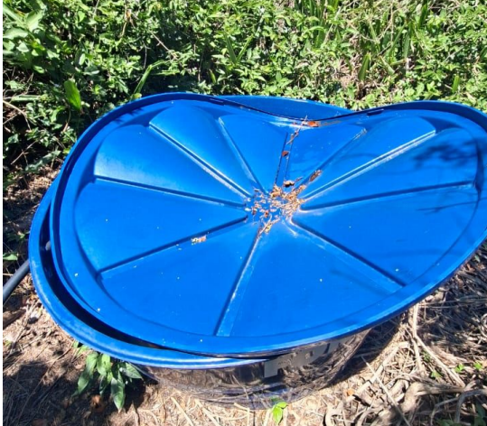
Figura 3. Caixa D'água danificada pelo sol intenso.
